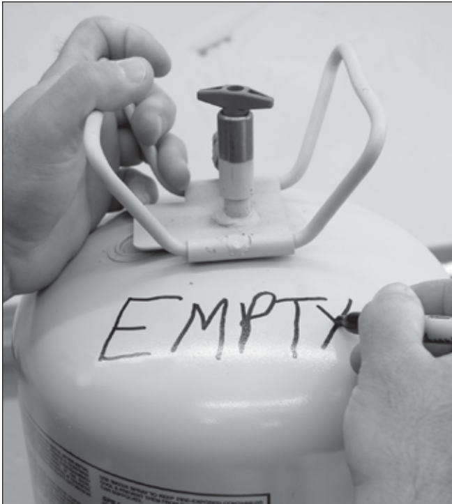
Los cilindros vacíos de refrigerante deben marcarse como “vacíos” antes de desecharse.
