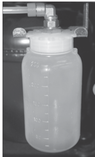
Aquí se puede observar un depósito regular típico de recuperación de aceite de un equipo o máquina de recuperación. Este debe vaciarse antes de cada recuperación, y después revíselo cuando se termine la recuperación para ver cuánto aceite (si hay) fue removido del sistema durante la recuperación. Si se removió algo de aceite, esa misma cantidad de aceite nuevo del tipo que el sistema requiere se debe reinstalar antes que el sistema opere de nuevo.
