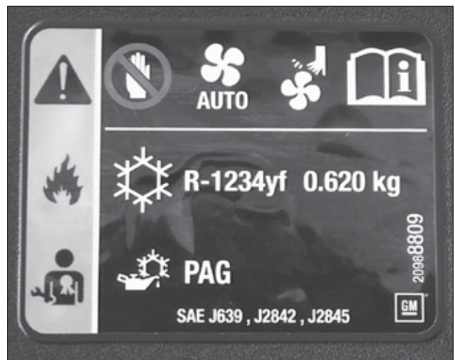
Etiqueta utilizada en el 2013 Cadillac XTS, el primer auto de GM en usar el nuevo refrigerante.
