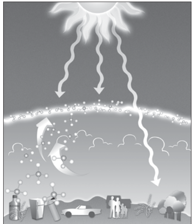
Los CFCs fueron utilizados para muchos propósitos diversos, incluyendo los refrigerantes en los sistemas móviles de A/C en o antes de 1992. Las fugas y otras descargas les permitían entrar a la atmósfera.
