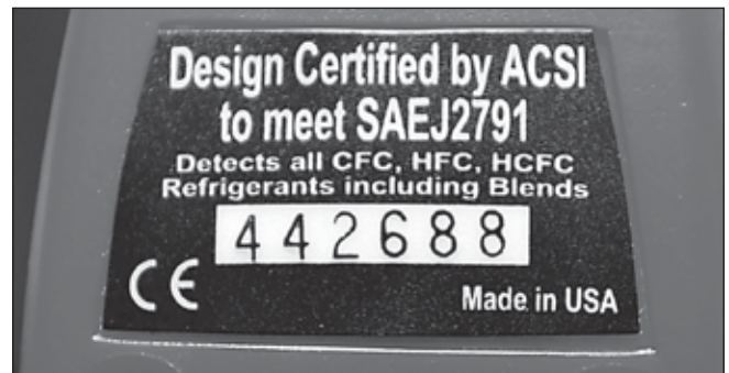
Etiqueta típica de certificación de un detector de fugas. Esta demuestra que este detector de fugas cumple con los requisitos mínimos de rendimiento descritos en el estándar SAE J2791.
