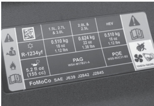
Una etiqueta de información del sistema de A/C de un vehículo mostrando el tipo de aceite lubricante que requiere el sistema.
