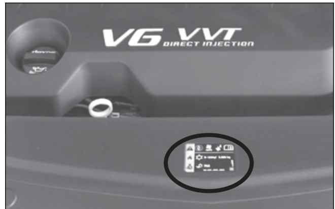
La etiqueta del refrigerante de este 2013 Cadillac XTS es fácil de encontrar, pero en otros vehículos puede que tenga que mirar a su alrededor.
