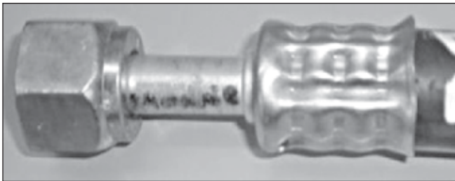
Este conjunto engarzado o prensado incorrectamente se giró y se volvió a prensar.
