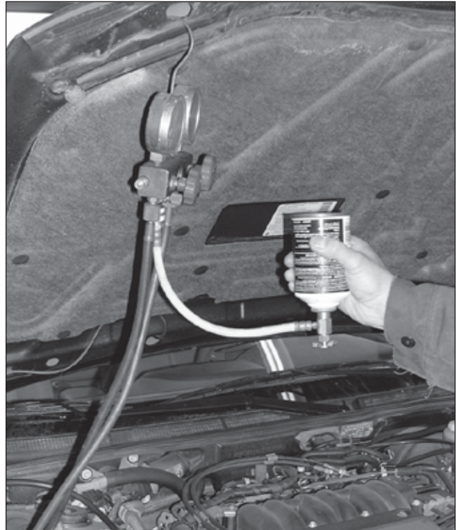
Algunos técnicos aún intentan utilizar latas pequeñas y un medidor de presión para cargar los sistemas, pero no es posible obtener una carga precisa con este método.
