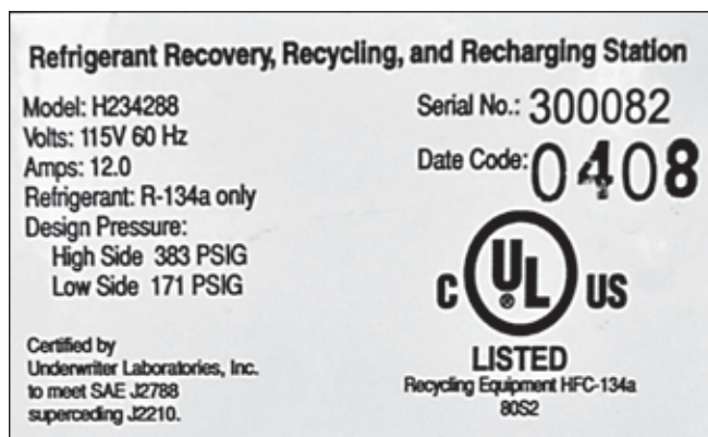
La etiqueta mostrada del equipo R/R/R del refrigerante establece: "certificado . . . para cumplir con la SAE J2788 reemplazando la J2210."
