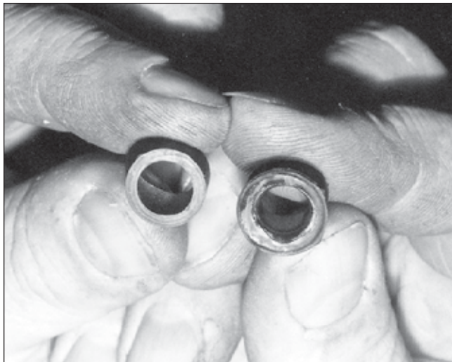
Los sellos en las mangueras del equipo de servicio deben ser revisados con frecuencia para ver si existen daños y sean reemplazados cuando sea necesario. Aquí se muestra una comparación entre un sello nuevo (a la izquierda) y uno usado inflamado y distorsionado (derecha).
