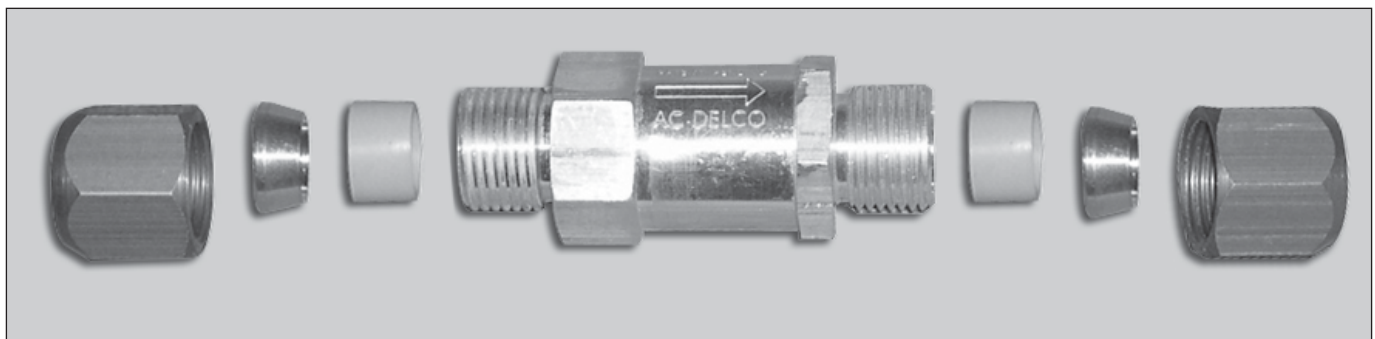
Se pueden instalar filtros para líquido entre medio de la línea para atrapar la suciedad que pueda haber en el sistema de A/C, después que el compresor haya sufrido una falla catastrófica. Los filtros de este tipo están disponibles de un gran número de proveedores de partes de aire acondicionado.
