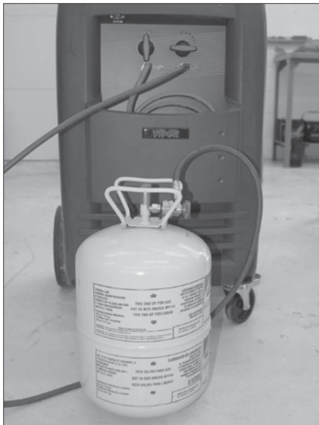
Antes que se descarten, los cilindros desechables de refrigerante deben conectarse al equipo de recuperación y someterlos al vacío. Esto asegurará que se remueva todo el refrigerante.
