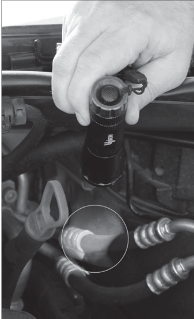
La fuga de tinte fosforece con la luz ultravioleta. (Cortesía CPS Automotive Group).
