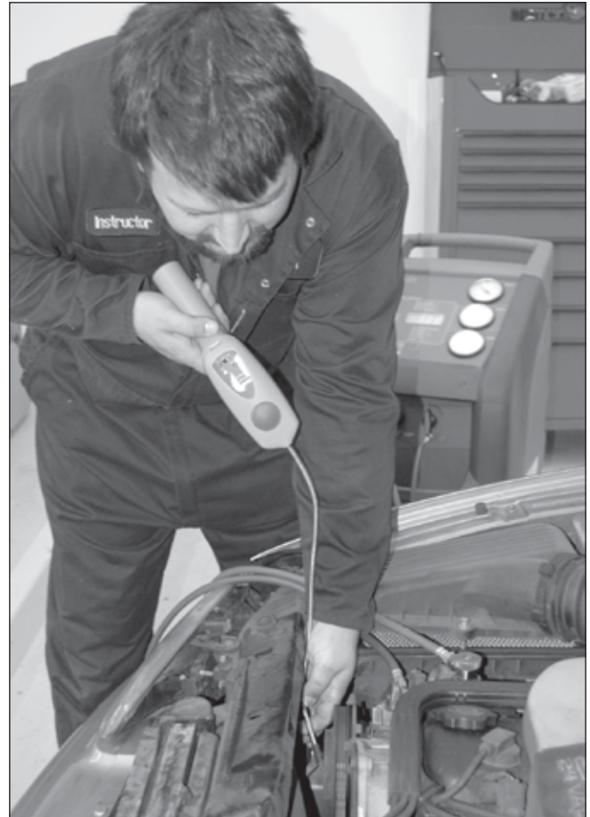
Su detector (es) electrónico de fugas debe estar certificado para cumplir con la especificación del SAE (el detector debe ser etiquetado como tal), y debe ser utilizado de conformidad con los procedimientos establecidos en la especificación SAE J1628. Se ha proporcionado una visión general del SAE J1628 bajo “El Uso de Detectores Electrónicos de Fugas” (página siguiente) y en el recuadro de la página 19.
